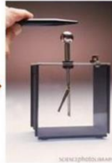
เมื่อนำวัตถุที่มีประจุเข้าใกล้ แผ่นโลหะขนานจะกางออก
